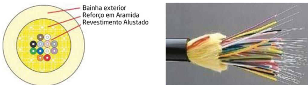
**Loose Tube (Solta)** - As fibras são alojadas dentro de um tubo cujo diâmetro é muito superior ao das fibras (*loose buffers*). Isto, por si só, isola as fibras das tensões externas presentes no cabo, tais como tracção, flexão ou variações de temperatura. Dentro deste tubo é aplicado um gel derivado de petróleo, com características de isolamento relativamente a humidades externas.
